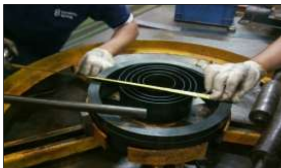
ภาพที่ 7 ภาพการประกอบชุดจับยึดสปริงลาน
