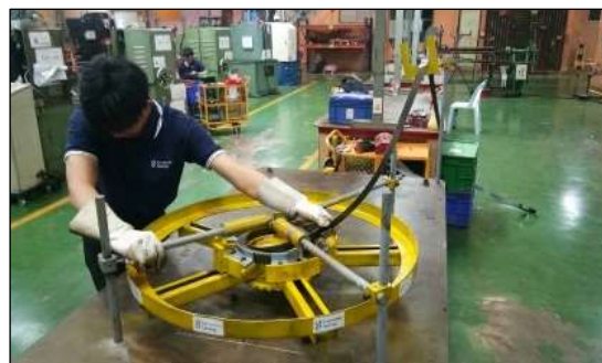
ภาพที่ 8 ภาพการประกอบชุดจับยึดสปริงลาน
