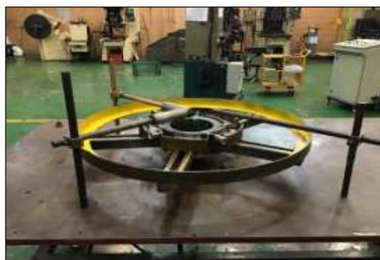
ภาพที่ 9 ภาพจับยึด Material กับอุปกรณ์ม้วนสปริงลาน
