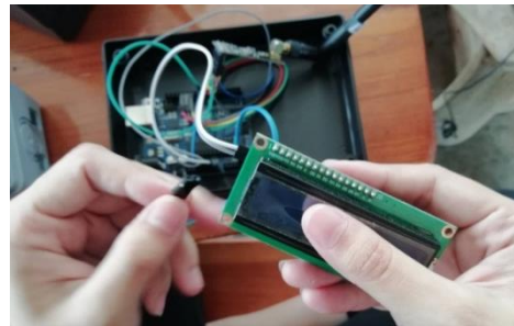
ภาพที่ 9 ภาพแสดงการประกอบอุปกรณ์รับสัญญาณขอความช่วยเหลือที่อยู่บ้านผู้ดูแลผู้สูงอายุ
