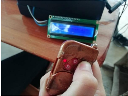
ภาพที่ 10 ภาพแสดงการทดสอบใช้งาน การรับส่งสัญญาณ
