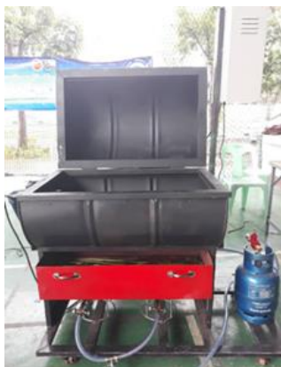
ภาพที่ 5 ภาพแสดงการทำฝาเปิดปิดถังบรรจุรังไข่ ขนาด 200 ลิตร
