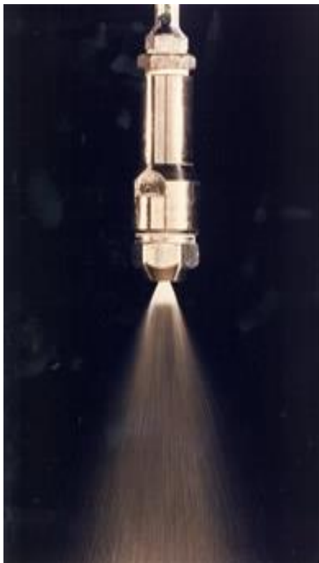
ภาพที่ 5 หัวฉีดพ่นฝอยขณะทำงาน (Nozzle atomizer)
