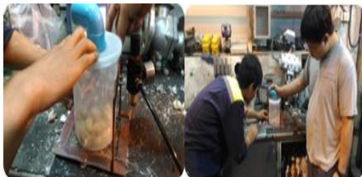
ภาพที่ 5 เครื่องปอกเปลือกกระเทียมอย่างง่าย
