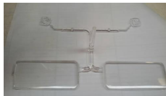
ภาพที่ 12 แสดงชิ้นงานที่ฉีดได้ในค่าพารามิเตอร์ครั้งที่ 1
