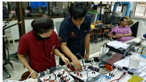
ภาพที่ 8 ภาพแสดงการทดสอบชุดสาคิตการควบคุมความเร็วรอบของมอเตอร์ไฟฟ้ากระแสตรงแบบลูปปิด
