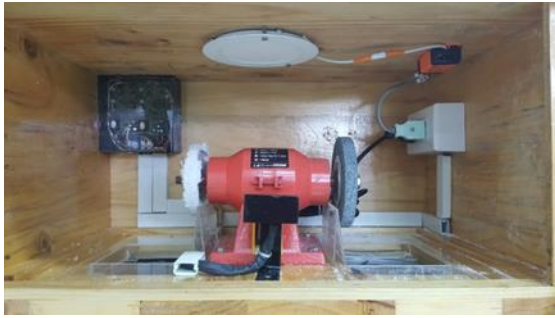
ภาพที่ 6 ภาพทำการติดตั้งเครื่องเจียร หลอดไฟ พัฒนาระบายอากาศและต่อเซ็นเซอร์ ตรวจจับความเคลื่อนไหว
