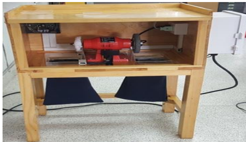
ภาพที่ 8 ภาพไ้ะเลี่ยมกรอบพระไร้ฝุ่นทำงาน โดยอัตโนมัติที่เสร็จสมบูรณ์
