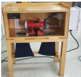
ภาพที่ 9 ภาพโต๊ะเลี่ยมกรอบพระไร้ฝุ่นทำงานโดยอัตโนมัติ
