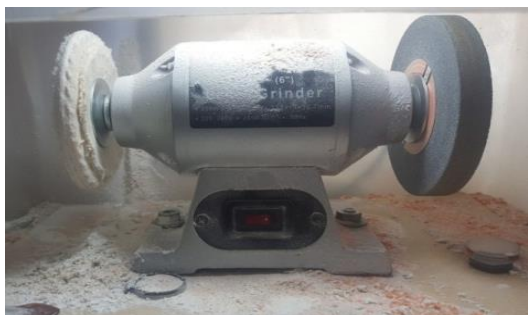
ภาพที่ 1 ภาพแสดงฝุ่นผงที่เกิดจากการเจียรแผ่นอะคริลิก
