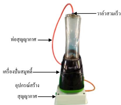
ภาพที่ 8 ภาพแสดงเครื่องปั่นสมูทตี้แบบสุญญากาศ
