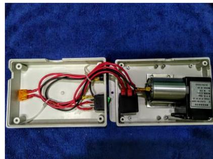
ภาพที่ 5 ภาพแสดงการต่อสายไฟเข้ากับอุปกรณ์ไฟฟ้าควบคุมปั้มสุญญากาศที่สมบูรณ์
