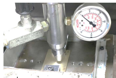
ภาพที่ 5 ภาพแสดงขนาดกระบวนการกดรีดชิ้นงานของอลูมิเนียมบรอนซ์ H5114
