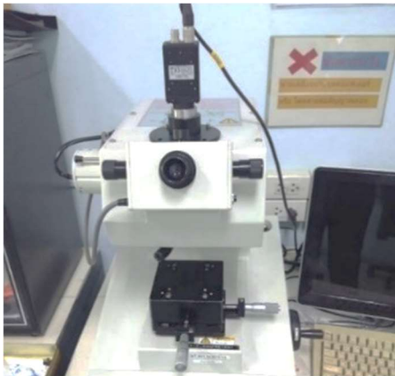
ภาพที่ 8 ภาพแสดงเครื่อง Microvic - Vickers Hardness Tester ยี่ห้อ Struers
