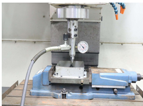
ภาพที่ 3 ภาพชุดอุปกรณ์จับยึดหัวบอล
