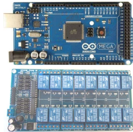
ภาพที่ 5 บอร์ด Arduino MEGA 2560 R3 และ Relay 16 CH 12 V 10 A
