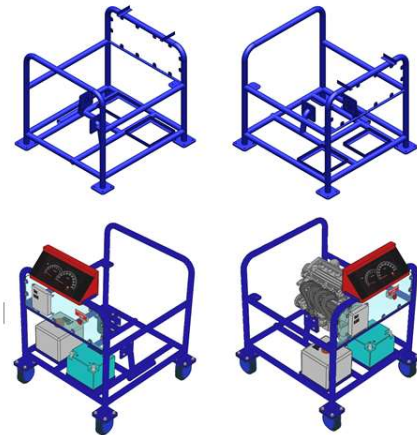
ภาพที่ 2 โครงสร้าง สำหรับนำเครื่องยนต์มาติดตั้ง
