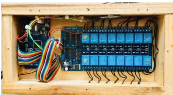
ภาพที่ 7 วงจรไฟฟ้าระบบจุดระเบิดอิเล็กทรอนิกส์
