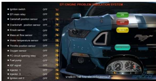
ภาพที่ 6 สร้างปุ่มควบคุมการทำงาน เพื่อส่งคำสั่งควบคุมไปยังบอร์ด Arduino MEGA 2560 R3 โดยส่งการผ่าน Bluetooth
