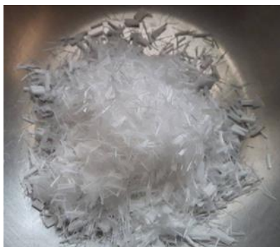
ภาพที่ 5 เส้นใยพอลิแลคติกแอซิดที่ตัดให้มีความยาว ประมาณ 5 มิลลิเมตร
