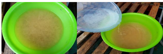
ภาพที่ 6 กระจายเยื่อในภาชนะ และผสมเยื่อและ พอลิแลคติกแอซิดเข้าด้วยกัน
