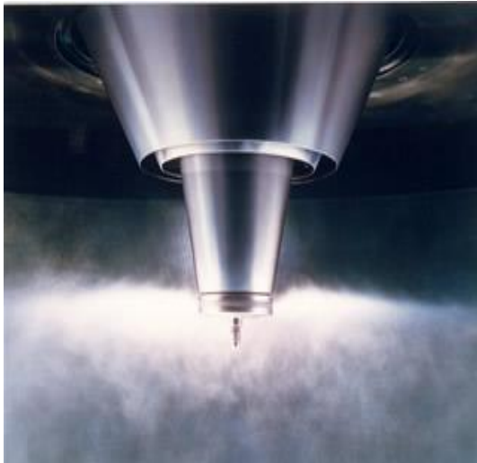
ภาพที่ 4 หัวฉีดพ่นฝอยขณะทำงาน (Rotary atomizer)
