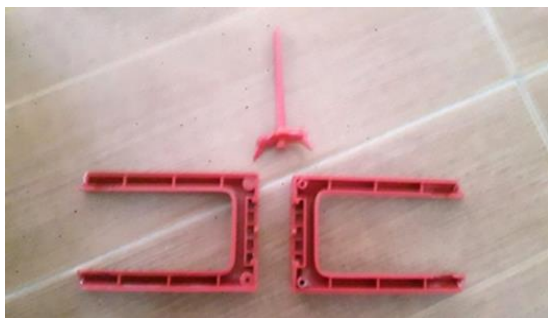
ภาพที่ 12 ภาพแสดงชิ้นงานที่ฉีดได้ในค่าพารามิเตอร์ครั้งที่ 1
