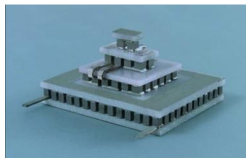
ภาพที่ 3 ภาพแสดงเทอร์โมอิเล็กทริกส์แบบหลายชั้น (Multistage Module)
