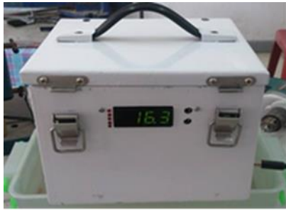
ภาพที่ 9 ภาพแสดงกล่องรักษาอุณหภูมิวัคซีนยาที่ทำความเย็นแผ่นเทอร์โมอิเล็กทริกส์
