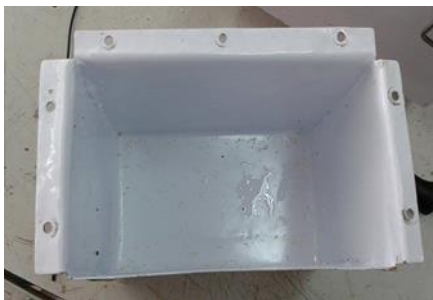
ภาพที่ 11 ภาพแสดงด้านในกล่องรักษาอุณหภูมิวัคซีนยาที่ทำความเย็นแผ่นเทอร์โมอิเล็กทริกส์
