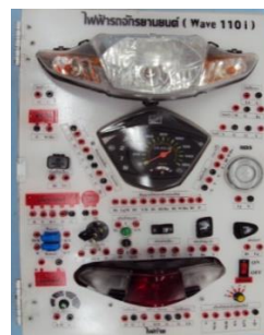
ภาพที่ 3 ภาพแสดงชุดสาธิตและฝึกปฏิบัติวงจรไฟฟ้ารถจักรยานยนต์ Honda Wave 110i
