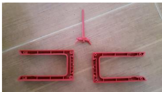
ภาพที่ 15 ภาพแสดงชิ้นงานที่ได้จากการฉีดด้วยค่าพารามิเตอร์ที่เหมาะสม
