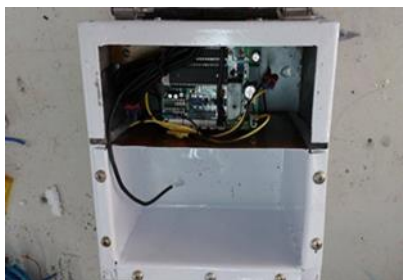
ภาพที่ 10 ภาพแสดงด้านในกล่องรักษาอุณหภูมิวัคซีนยาที่ทำความเย็นแผ่นเทอร์โมอิเล็กทริกส์ และวงจรตรวจอุณหภูมิ
