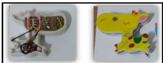
ภาพที่ 5 ภาพการประกอบวงจรลงในแบบ
