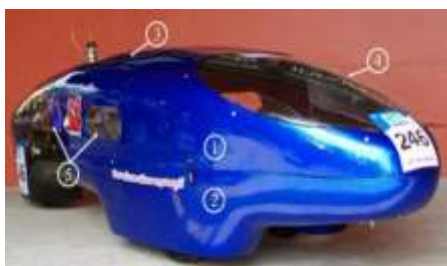
ภาพที่ 6 ภาพแสดงตัวถังรถประหยัดน้ำมัน เชื้อเพลิงกึ่งอัตโนมัติ Autokan1
