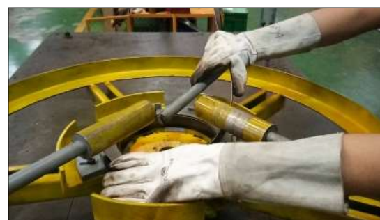
ภาพที่ 10 ภาพทดลองม้วน อุปกรณ์ม้วนสปริงลาน
