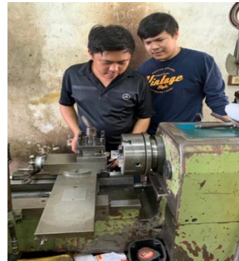
ภาพที่ 5 ภาพแสดงการกลึงหน้าแปลนชุดตรวจสอบ รอยรั้วของอีวาพอเรเตอร์
