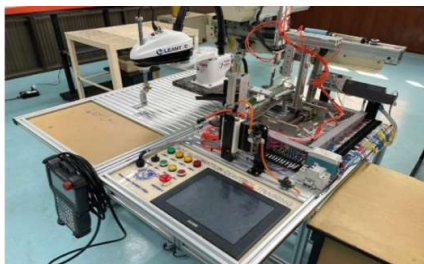
ภาพที่ 3 ชุดทดลองหุ่นยนต์และระบบอัตโนมัติในงานอุตสาหกรรมผ่านระบบการสื่อสาร IIOT
