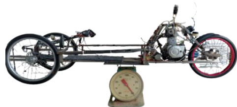
ภาพที่ 3 ชั่งน้ำหนักโครงรถ
