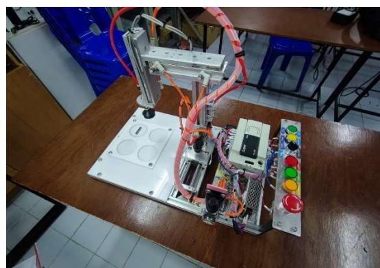
ภาพที่ 2 เตรียมอุปกรณ์และเครื่องมือถอดชุดทดลองเคลื่อนย้ายวัตถุทำงานด้วยโปรแกรมเมเบิลคอนโทรลเลอร์
