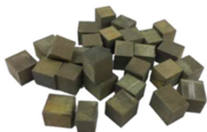
ภาพที่ 1 ภาพวัสดุ Inconel 738 ที่ใช้งานแล้ว
