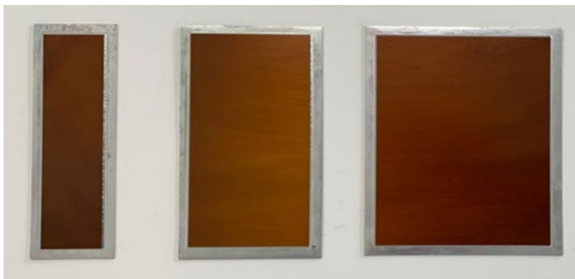
รูปที่ 2 บล็อกแม่พิมพ์ตะกั่ว 3 ขนาด คือ 2.5 \times 10 เซนติเมตร (25%), 5 \times 10 เซนติเมตร (50%), 7.5 \times 10 เซนติเมตร (75%) ตามลำดับ และเครื่องสำหรับการเดินรอยร้อน
