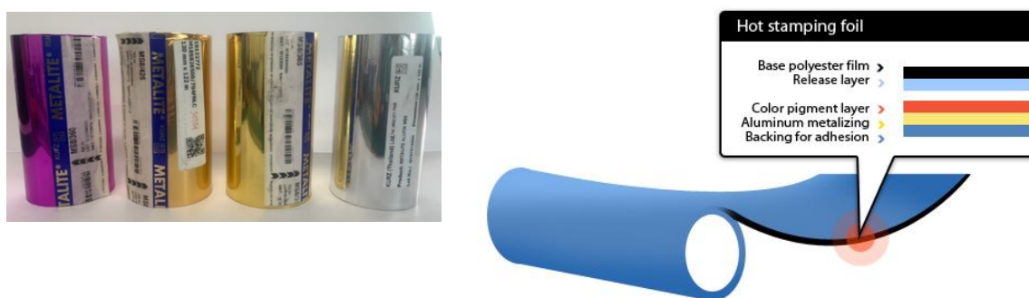
รูปที่ 1 ม้วนฟอยล์จาก บจก. เคิร์ช (ประเทศไทย) และองค์ประกอบในชั้นต่าง ๆ ของฟอยล์ที่ใช้เดินรอยร้อน [2]
