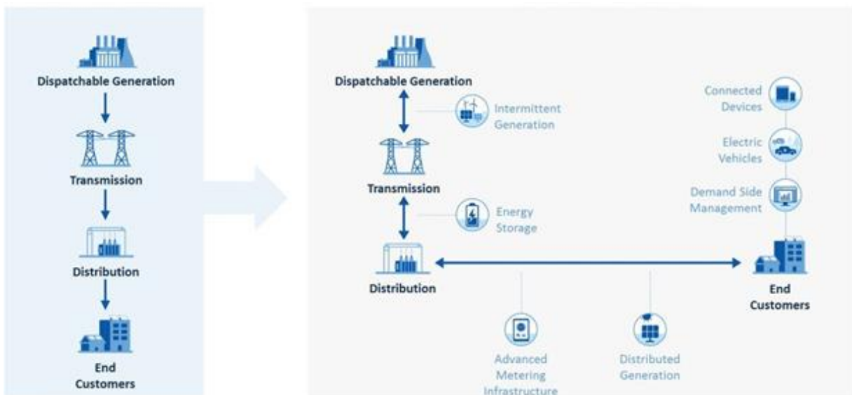
รูปที่ 14 ระบบไฟฟ้าแบบรวมศูนย์และแบบกระจายศูนย์
