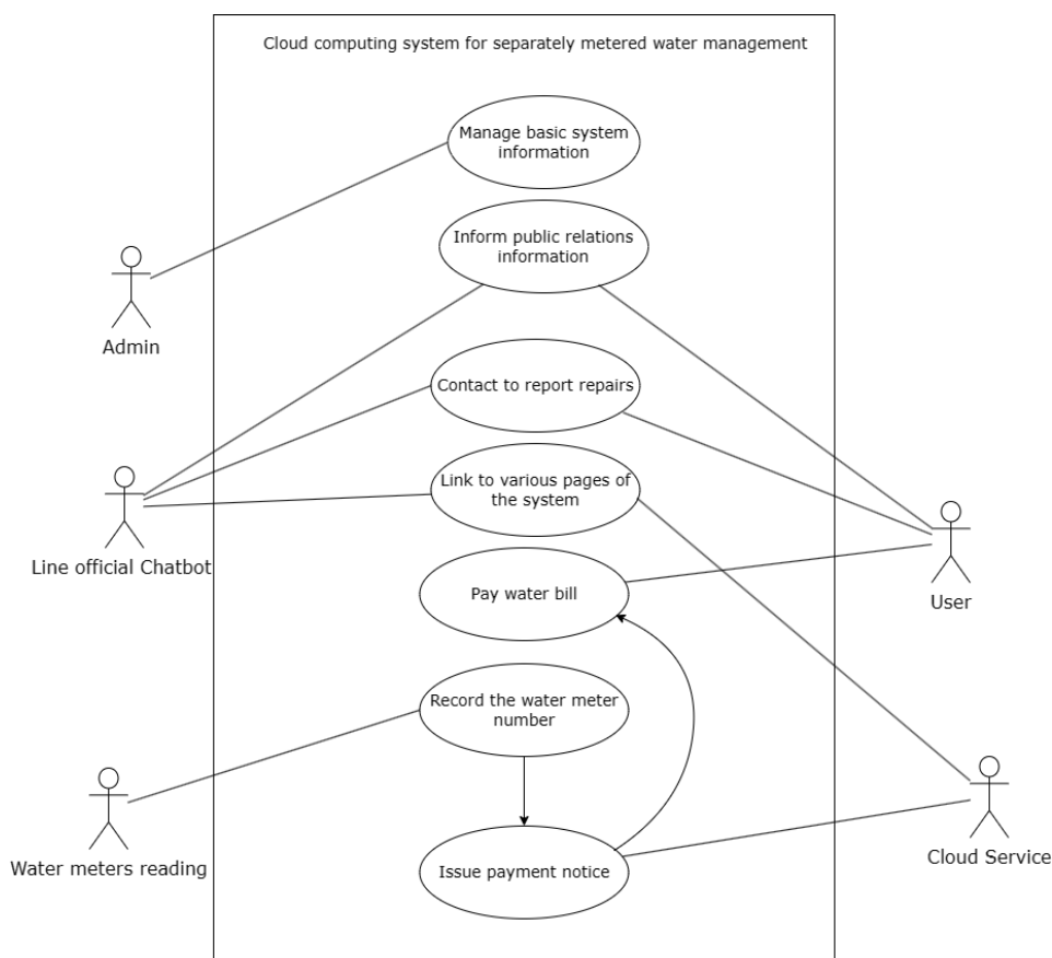
รูปที่ 1 แสดง Use Case Diagram ของระบบประมวลผลบนคลาวด์
