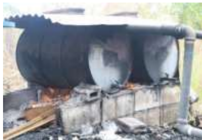
ภาพที่ 4 เตาnungก้อนเชื้อเห็ด แบบดั้งเดิม (คณะผู้วิจัย)
