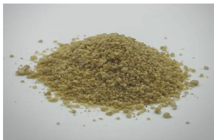
ภาพที่ 7 แผ่นไบโอเรซิน (Bioresin) ยางนาที่บดเป็นผงของสูตรที่ 13.5 มีลักษณะที่เป็นเม็ดและไม่เกาะกันเป็นก้อนเหนียว
