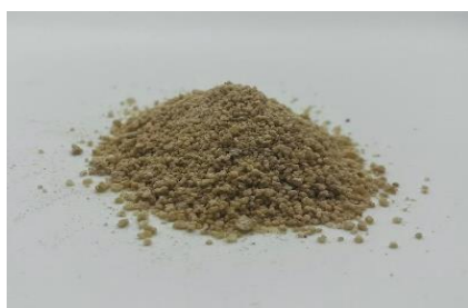
ภาพที่ 6 แผ่นไบโอเรซิน (Bioresin) ยางตะเคียนทองที่บดเป็นผงของสูตรที่ 13.5 มีลักษณะที่เป็นเม็ดและไม่เกาะกันเป็นก้อนเหนียว
