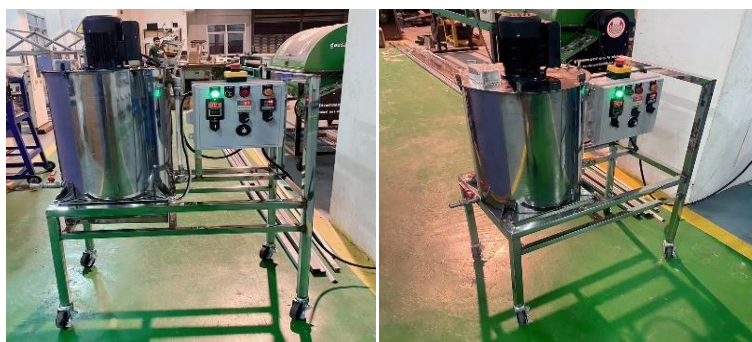
ภาพที่ 3 การสร้างเครื่องกวนโคโตซานระบบกึ่งอัตโนมัติต้นแบบ สำหรับชุมชน
