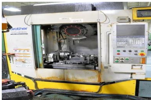
ภาพที่ 1 เครื่องกัดซีเอ็นซีรุ่น Brother TC S2D CNC Tapping Center
