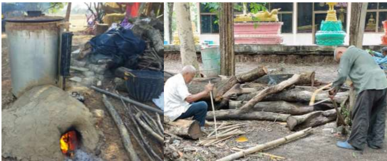
ภาพที่ 3 การเผาเศษไม้ไผ่จากหัตถกรรมจักสานด้วยเตาเผาขยะไบโอชาร์
