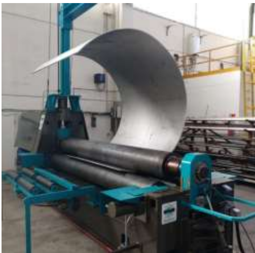
ภาพที่ 7 เครื่องจักร Steel Plate Rolling Machine สำหรับสร้าง Absorption Tower
