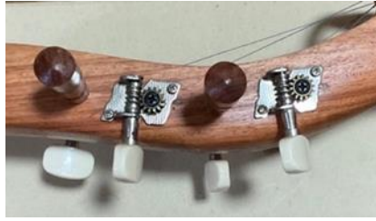
ภาพที่ 4 ลูกบิดกีตาร์มาใช้แทนลูกบิดแบบดั้งเดิม
