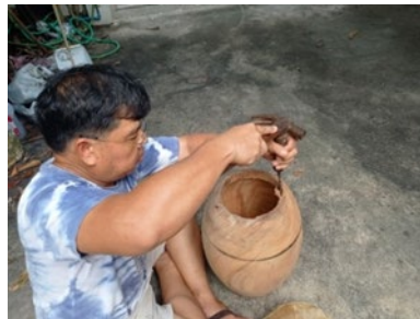
ภาพที่ 1 การใช้สิ่วเจาะบริเวณปากนกแก้ว ที่มา: ชนะใจ รื่นเริง
