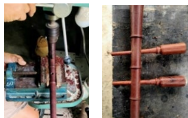
ภาพที่ 9 และ 10 การเจาะรูคันทวนประกอบลูกบิด และการประกอบลูกบิดเข้ากับคันทวน ที่มา: ชลพรพร เด็ใจ
