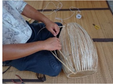
ภาพที่ 9 การสาวตะโพนด้วยการใช้หัวเข่าเป็นอวัยวะค้ำยันหุ่นกลอง ที่มา: ชนะใจ รื่นเริง
