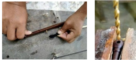
ภาพที่ 11 และ 12 การเจาะรูที่ปลายคันชัก และการใส่หางม้าเข้ากับคันชักบนแท่นขึ้นหางม้า ที่มา: ชลพรพร เด็จใจ
