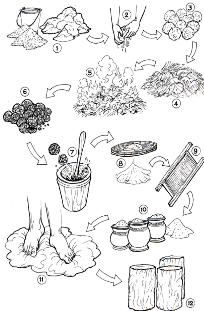
ภาพประกอบที่ 6 แสดงขั้นตอนการเตรียมดินปั้น จากการทำดินเชื้อเพื่อเอาไว้มผสมกับเนื้อดินสำหรับปั้น
