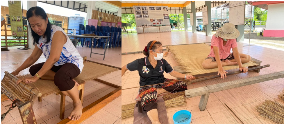
ภาพประกอบที่ 3 ทำนั้งในการทอเสื่อด้วยเครื่องทอเสื่อแบบเดิม ที่ต้องนั่งก้มโน้มตัวไปข้างหน้าและพับขาตลอดกระบวนการทอเสื่อ
