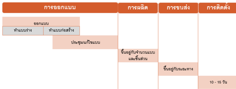
ภาพที่ 1 กระบวนการก่อสร้างทาวน์เฮาส์ที่ก่อสร้างด้วยชิ้นส่วนคอนกรีตสำเร็จรูปของ บริษัท พุกษา เรียลเอสเตท จำกัด (มหาชน)
