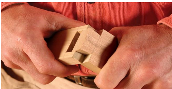
ภาพที่ 1.3 ตัวอย่างการประสานไม้แบบเดือยตัวผู้ต่อตัวเมีย
