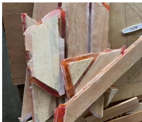
ภาพที่ 1 ความผิดพลาดจากการประสานไม้แบบเรซิน
