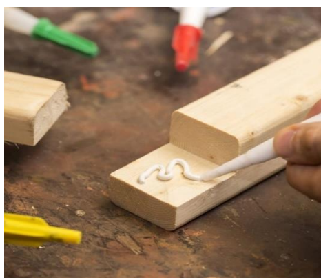
ภาพที่ 2.2 การประสานไม้แบบใช้กาว
