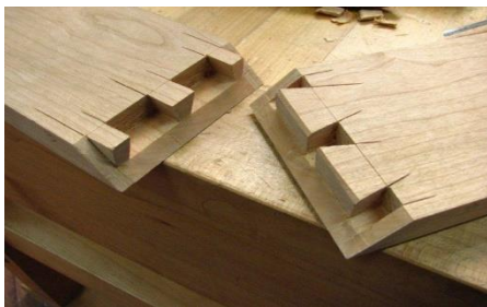
ภาพที่ 1.1 การประสานไม้แบบเดือยตัวผู้ ตัวเมีย
