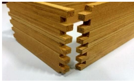
ภาพที่ 1.2 การประสานไม้แบบเดือยตัวผู้ ตัวเมีย
