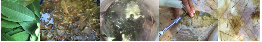
ภาพที่ 3 การขึ้นรูปวัสดุโดยวิธีการประสานด้วยน้ำยางพารา
