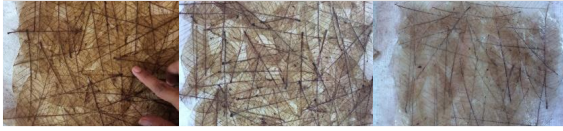
ภาพที่ 5 การขึ้นรูปวัสดุโดยวิธีการประสานด้วยยูนิเทน
