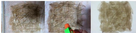
ภาพที่ 4 การขึ้นรูปวัสดุโดยวิธีการประสานด้วยกาวน้ำ
