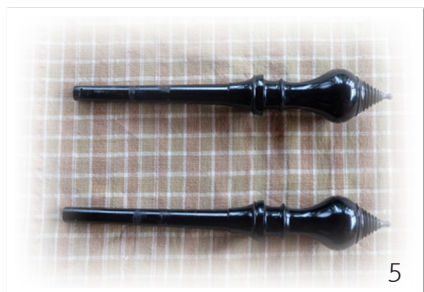
ภาพที่ 5 - 6 การกลึงยอดฉัตรลูกบิดและลูกบิดที่เสร็จสมบูรณ์แล้ว
