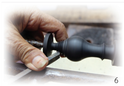
ภาพที่ 5 - 6 การกลึงยอดฉัตรลูกบิดและลูกบิดที่เสร็จสมบูรณ์แล้ว
