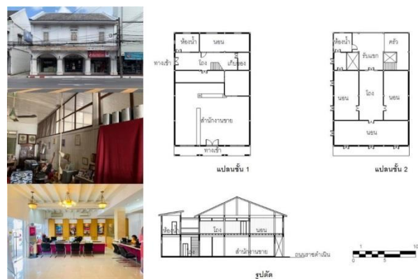
ภาพที่ 9 แสดงภาพและรายละเอียดส่วนผังบริเวณและรูปตัดของมรดกสถาปัตยกรรมพื้นถิ่นทรงคุณค่า F19
