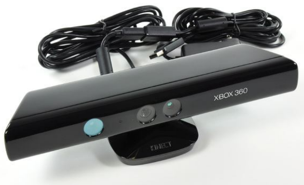
ภาพประกอบ 2 แสดงอุปกรณ์ Kinect
