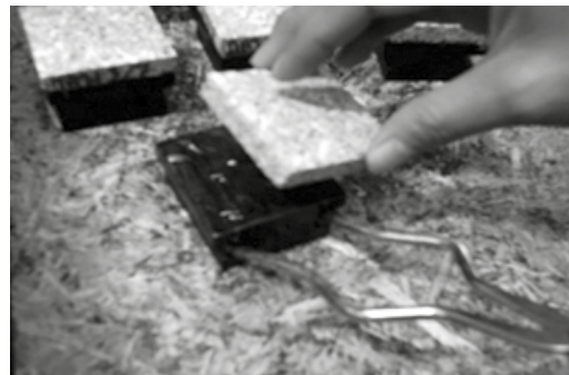
ภาพที่ 17 นำแผ่นทดสอบติดยึดกับแป้นเหล็ก
