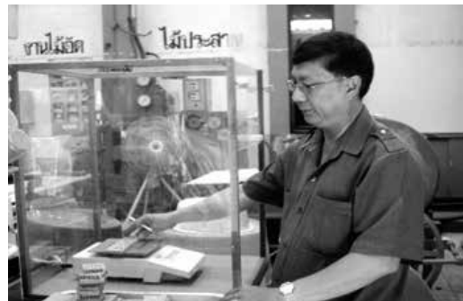
ภาพที่ 13 ชั่งน้ำหนักของแผ่นทดสอบ เพื่อหาค่าความชื้นและความหนาแน่น
