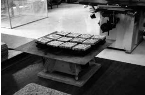
ภาพที่ 19 นำไปตั้งบนเตาไฟฟ้า เพื่อให้กาวละลายติดกับเนื้อเหล็ก
