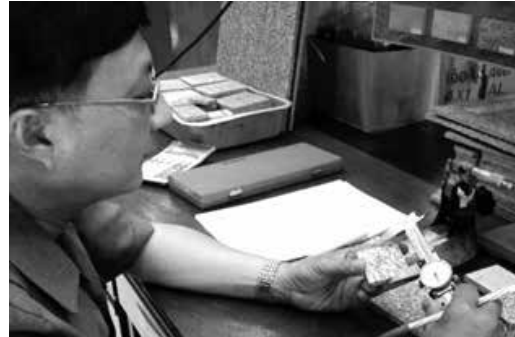
ภาพที่ 12 ตัดย่อยขนาด 50x50 มิลลิเมตร และ 50x150 มิลลิเมตร
