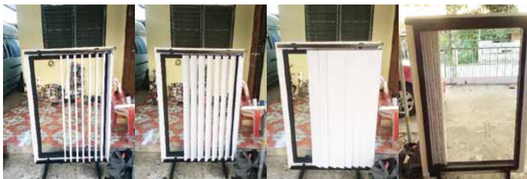
ภาพที่ 8 ทดสอบการทำงานของต้นแบบชิ้นงานระแนงบังแดด
