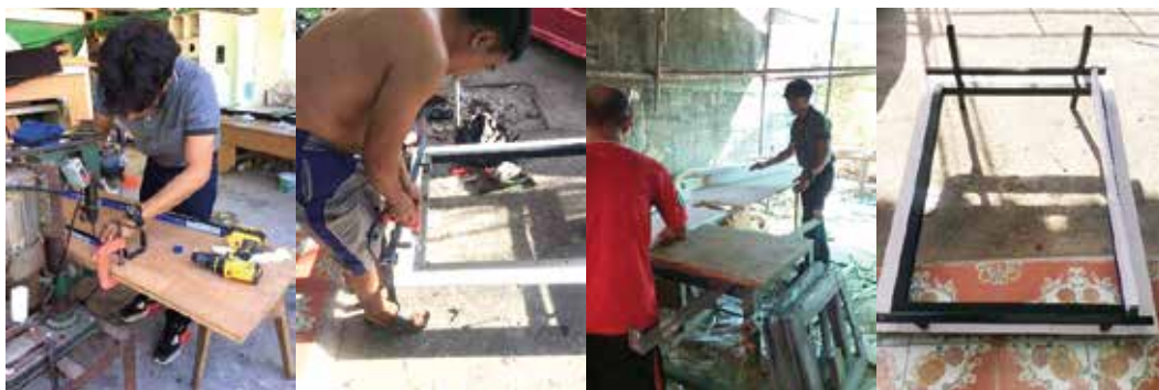
ภาพที่ 7 สร้างต้นแบบชิ้นงานระแนงบังแดด
