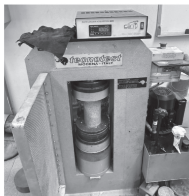
ภาพที่ 15 การนำก้อนตัวอย่างคอนกรีต ทำการทดสอบด้วยเครื่องทดสอบความ ต้านทานกำลังของแรงอัด
