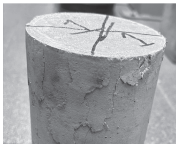
ภาพที่ 13 ถอดแบบก้อน คอนกรีตที่อายุ 24 ชั่วโมง
