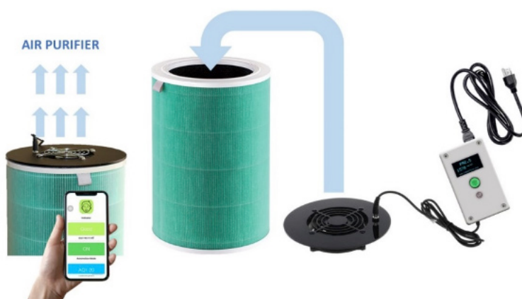
ภาพที่ 3 การทำงานของอุปกรณ์ควบคุมเครื่องฟอกอากาศแบบ DIY อัตโนมัติด้วยระบบ IoT ที่มา: ไพบุลย์ สมนึก และรณภูมิ นาคสมบุรณ์
