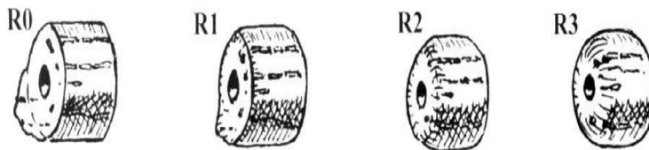
ภาพที่ 4 แสดงลูกบิดที่ผลิตด้วยวิธีดึง จะปรากฏฟองอากาศในแนวยาวและมีร่องรอยที่เกิดจากการตัด ซึ่งสามารถแบ่งออกได้หลายระดับ คือ R0: มีร่องรอยเหลือมาก เพราะโดนความร้อนน้อย, R1: ได้รับความร้อนพอประมาณ จึงลบรอยตัดได้บ้าง, R2-3: ได้รับความร้อนเหมาะสม จึงได้ลูกบิดที่มีรอยตัดกลมมน
