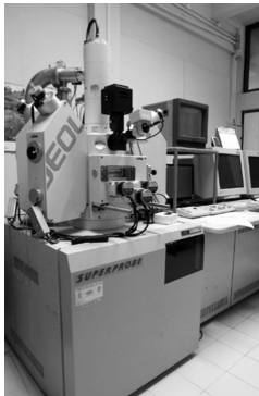
ภาพที่ 5 เครื่อง Electron Probe Micro-Analyzer (EPMA) ของภาควิชาธรณีวิทยา คณะวิทยาศาสตร์ จุฬาลงกรณ์มหาวิทยาลัย และตัวอย่างภาพถ่ายพื้นผิวของลูกปิดแก้วภายในเครื่อง EPMA ระหว่างเลือกพื้นที่เพื่อวิเคราะห์ธาตุประกอบทางเคมี
