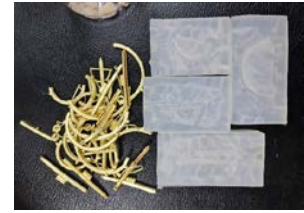
ภาพ ข แม่พิมพ์ซิลิโคนใสและตัวเรือนที่ได้จากการหล่อโลหะ
