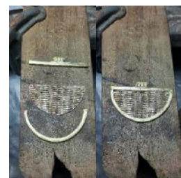
ภาพ ข ตัดแผ่นทองประกอบเข้ากับตัวเรือน
