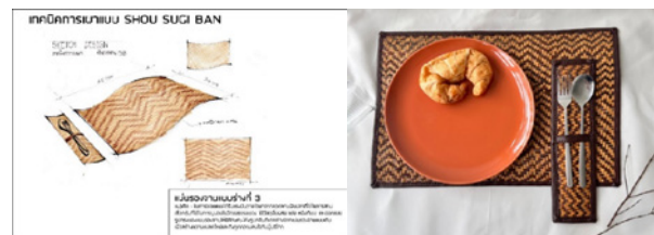
ภาพที่ 5 แบบร่างแผ่นรองจาน (ซ้าย) ต้นแบบ(ขวา) ที่ใช้เทคนิคการเผาแบบเซาสุกิบันที่ได้รับคะแนนสูงสุด ออกแบบโดยนำเอาอาสนะรองนั่งมาเปลี่ยนหน้าที่ใช้สอย และออกแบบลายสานใหม่โดยประยุกต์จากลายเดิม ที่มา: ภาพโดยผู้วิจัย ณภัค แสงจันทร์
