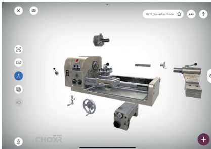
ภาพที่ 8 ภาพแยกส่วนเครื่องกลึงในเทคโนโลยีความเป็นจริงเสริม
