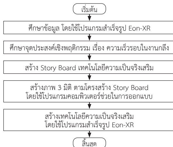
ภาพที่ 2 กระบวนการพัฒนาเทคโนโลยีความเป็นจริงเสริม เรื่อง ความเร็วรอบในงานกลึง
