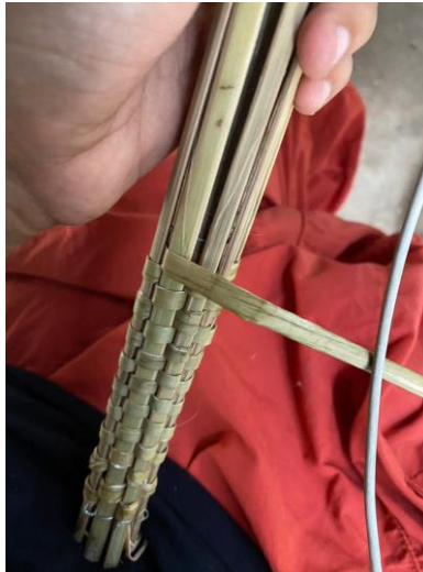
ภาพที่ 8 การขึ้นโครงด้วยไม้ไผ่ (ลำตัน)
