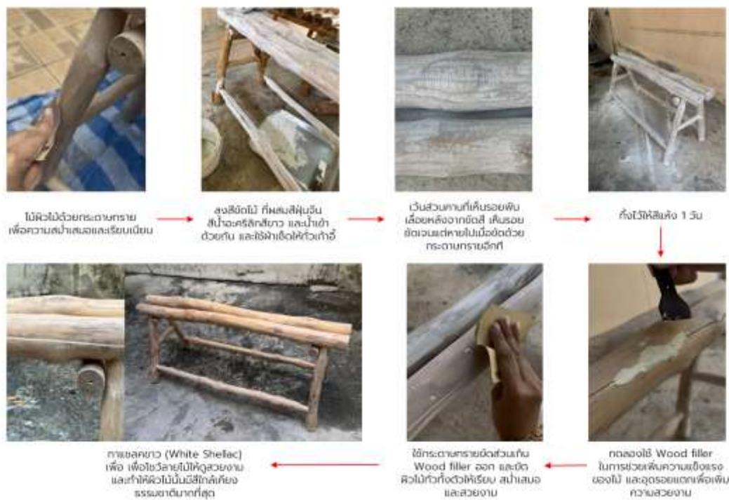
ภาพที่ 10 ทดลองด้วยเทคนิคการขัดเส้นไม้ขาวและโป้วรอยแตกด้วย wood filler
