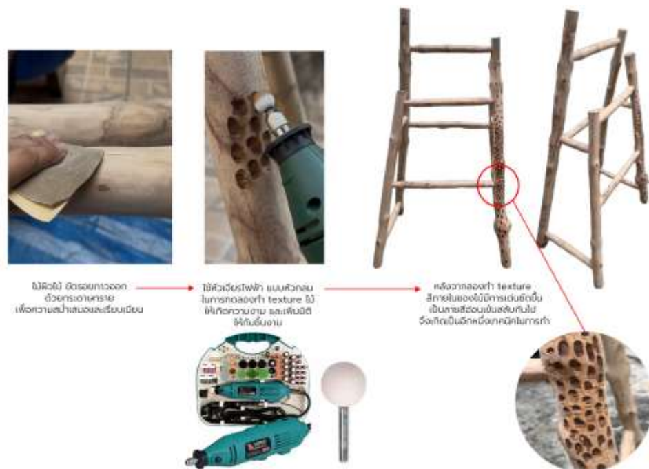
ภาพที่ 12 ทดลองด้วยเทคนิคการทำ Texture ไม้โดยใช้เครื่องเจาะไฟฟ้า
