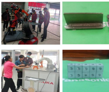
ภาพที่ 1 ปฏิบัติการฝึกทักษะการใช้หุ่นยนต์เชื่อม และระบบอัตโนมัติ
