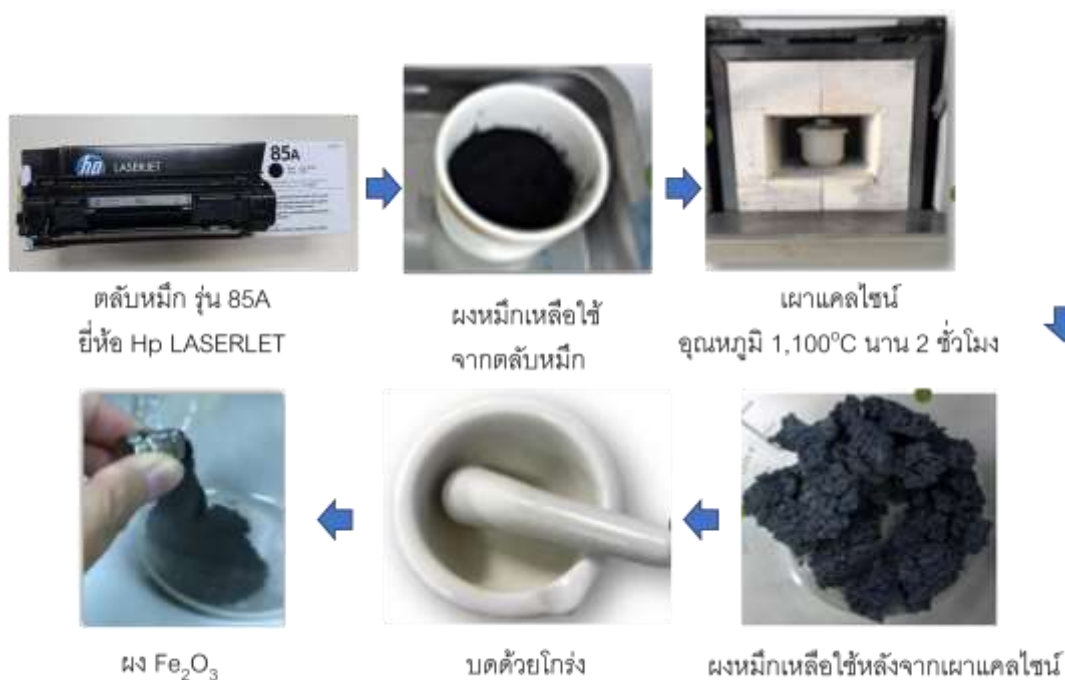
รูปภาพที่ 1 ขั้นตอนการสังเคราะห์ผง \text{Fe}_2\text{O}_3
