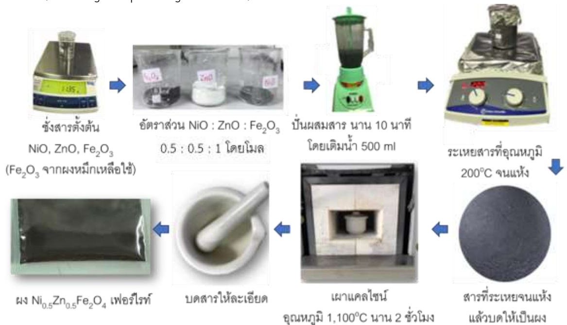
รูปภาพที่ 2 การสังเคราะห์ผง \text{Ni}_{0.5}\text{Zn}_{0.5}\text{Fe}_2\text{O}_4 เฟอร์ไรต์
